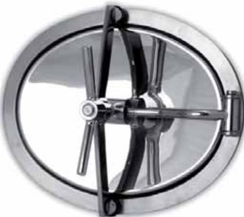
**Portella ovale in acciaio AISI 304 o AISI 316/L - apertura interna con possibilità di fuoriuscita del coperchio telaio di piatto inox mm.30x12 luce utile di passaggio mm. 440 x 340. Omologata PED**
