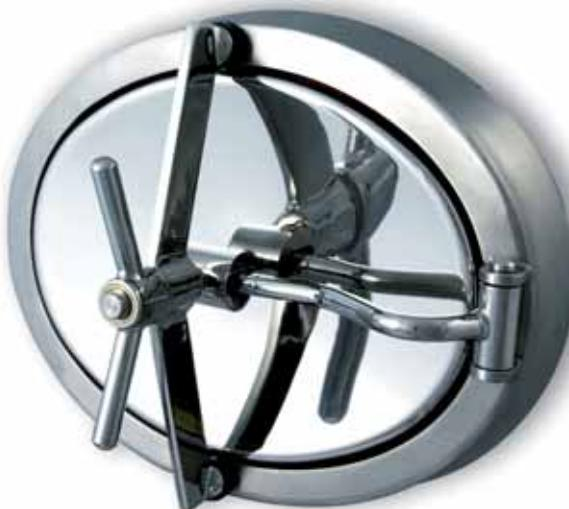
**Portella ovale tipo "succhi di frutta" in acciaio AISI 304 o AISI 316 - apertura interna con possibilità di fuoriuscita del coperchio telaio di piatto inox mm. 30 x 12 Hmm. 80 x 3. Luce utile di passaggio mm. 440 x 340**
