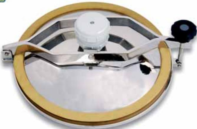
Chiusino superiore tipo "export" in acciaio inox AISI 304 o AISI 316 - con valvola compensatrice di pressione ø 50 apertura verticale ed orizzontale - luce utile di passaggio mm. 420
