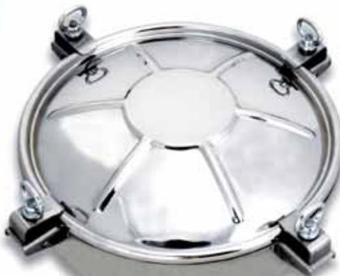
Chiusino superiore in acciaio inox AISI 304 o AISI 316 - luce utile di passaggio mm. 150 - 200 - 250 - 300 - 360 - 385 - 420 - 455 - 500 - 600. N.B.: su questo chiusino sono applicabili le valvole. Art. E 25 - E 26 - E 27 - E 28 - E 29.
