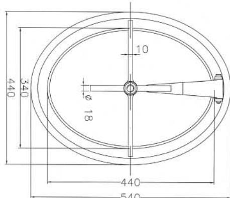
Portella ovale tipo "succo di frutta" in acciaio AISI 304 o AISI 316 - apertura interna - telaio di piatto inox mm. 30 x 12 H mm. 80 x 3. Luce utile di passaggio mm. 440 x 310
